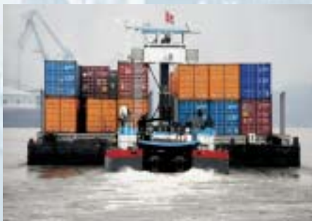
Unser Hafen-Shuttle zwischen den Terminals in Hamburg wird erweitert. Auf der Elbe setzt die DBR Schubverbände für 3-lagigen Containertransport ein.
